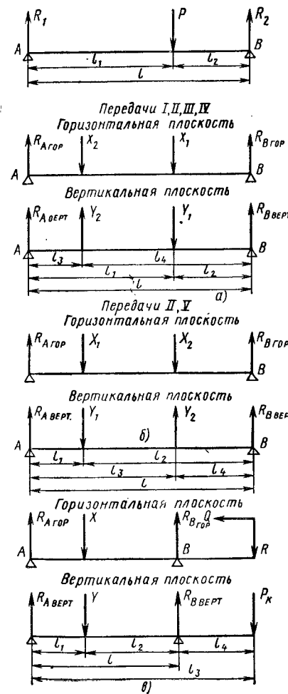
Рис. 7.6. Схема для расчета валов коробки передач (продольный вид): a — первичного; б — промежуточного; в — вторичного
